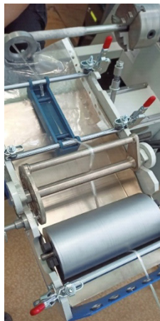
Рис. 1 Устройство для формирования композитных труб методом намотки
