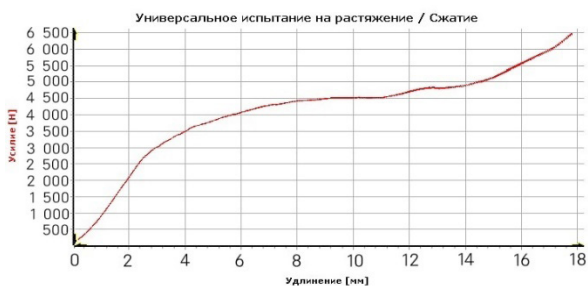
Рис. 7 Кривые упруго-пластического деформирования композитной трубы, на разных участках. Предельная нагрузка 4,5
