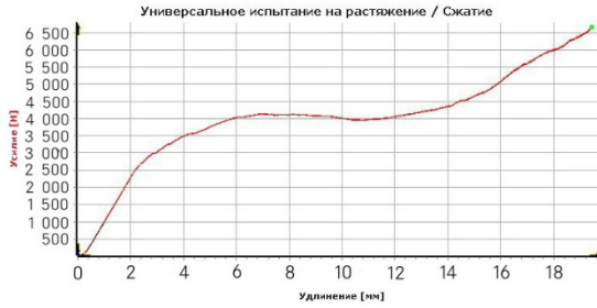
Рис. 9 Кривые упруго-пластического деформирования композитной трубы, на разных участках. Предельная нагрузка 4,1
