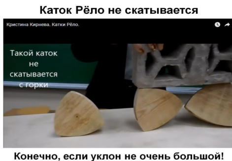
Рис. 3. Свободный каток Рёло не скатывается с горки, безопасен
