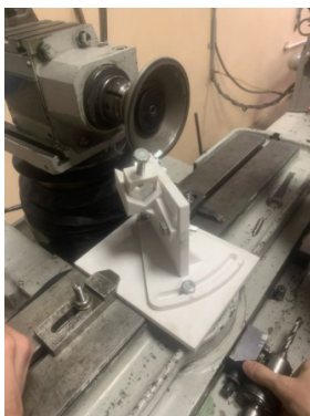
Рис.1 Приспособление, установленное на плите
