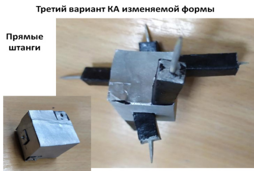
Рис. 5. Выдвижение штанг вдоль рёбер космического аппарата типа CubeSat
