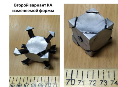
Рис. 4. Изменение формы и удлинения КА выдвигаемыми штангами
