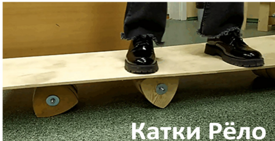
Рис. 4. Испытание безопасных катков Рёло
