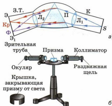
Рис. 1 Конструкция б) и оптическая схема а) спектроскопа.
