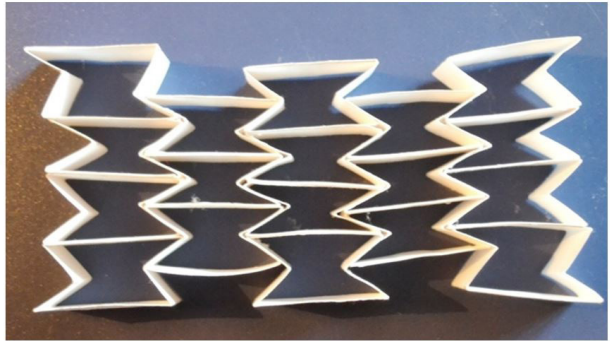
Рис. 1. Пример Д.С.Лисовенко о гвозде-ауксетике и классическая структура
