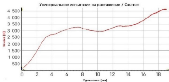
Рис. 6 Кривые упруго-пластического деформирования композитной трубы, на разных участках. Предельная нагрузка 3,3
