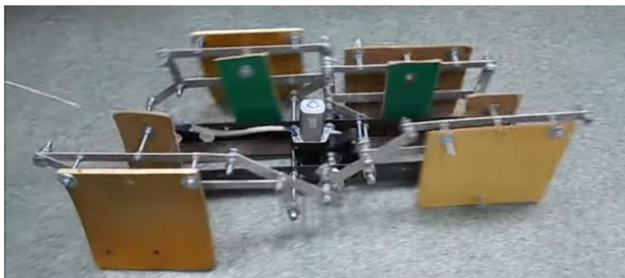
Рис. 3. Параллелограммы для последовательности кулачковых шагающих опор
