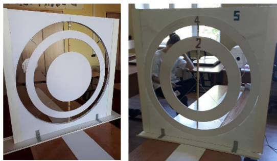
Рис. 1. Вид зонной пластинки и устройство крепления зон
